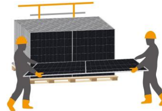
⑥ Coloque a estrutura de suporte para desembalar (Observe que a estrutura de suporte deve ser mais larga do que ou mais alta que o módulo para evitar que ele bata no vidro e cause danos ao módulo)
