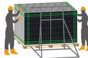
⑥ Coloque a estrutura de suporte para desembalar (Observe que a estrutura de suporte deve ser mais larga do que ou mais alta que o módulo para evitar que ele bata no vidro e cause danos ao módulo)
